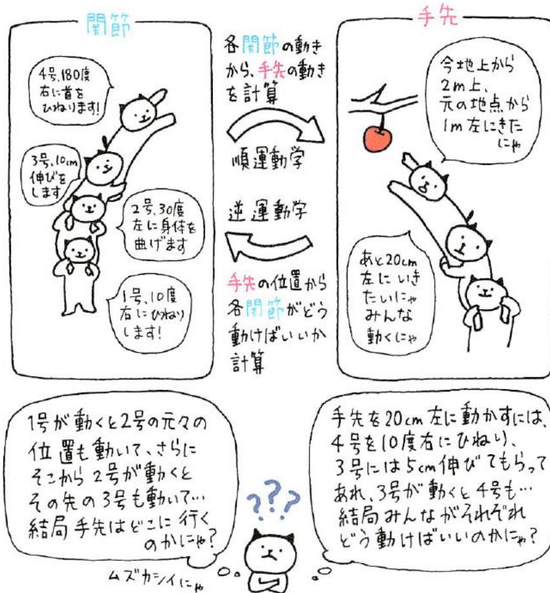
図 2.58 マニピュレータを動かすのには難しい計算が必要に
